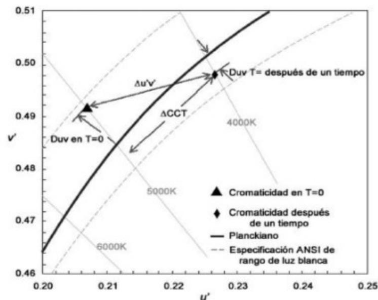
Figura L1 - Diagrama de cromaticidad que ilustra la diferencia entre  $Du'v'$ ,  $DDuv$  y  $DTCC$
