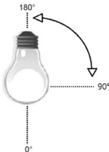
**Figura F1 - Ángulos sólidos verticales de medición de  $90^\circ$  a  $180^\circ$**
