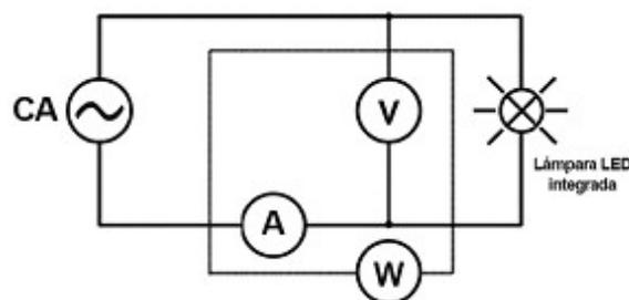
**Figura A1 - Circuito de prueba para Lámparas de led integradas****A.3.5. Estabilización.**
